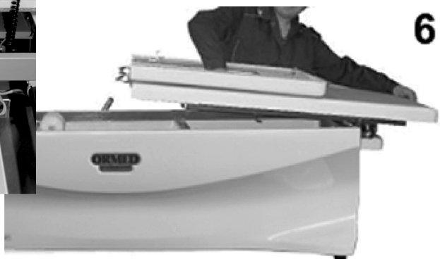
Фото 8. Снятие секций кушетки при техническом обслуживании
