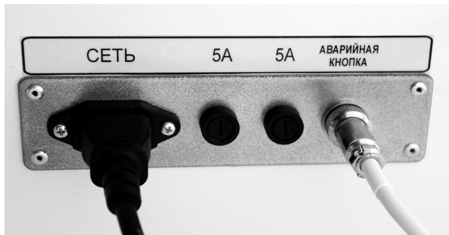
Фото 5. Задняя панель Установки (схема подключения кабелей)
